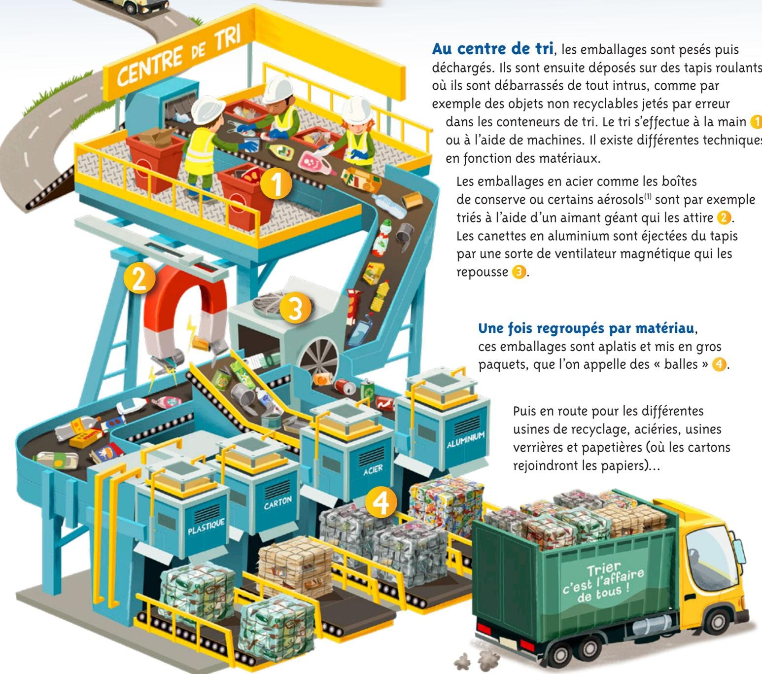
**Au centre de tri**, les emballages sont pesés puis déchargés. Ils sont ensuite déposés sur des tapis roulants où ils sont débarrassés de tout intrus, comme par exemple des objets non recyclables jetés par erreur dans les conteneurs de tri. Le tri s'effectue à la main **1** ou à l'aide de machines. Il existe différentes techniques en fonction des matériaux.
